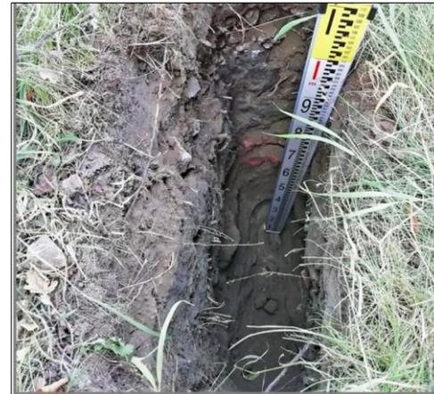
Abbildung 12: Blick in die Schachtung Nummer 2. Deutlich treten im Bodenprofil die intensiv durchwurzelte Schotterschicht sowie die darunter liegende Schicht aus Backsteinen hervor.
