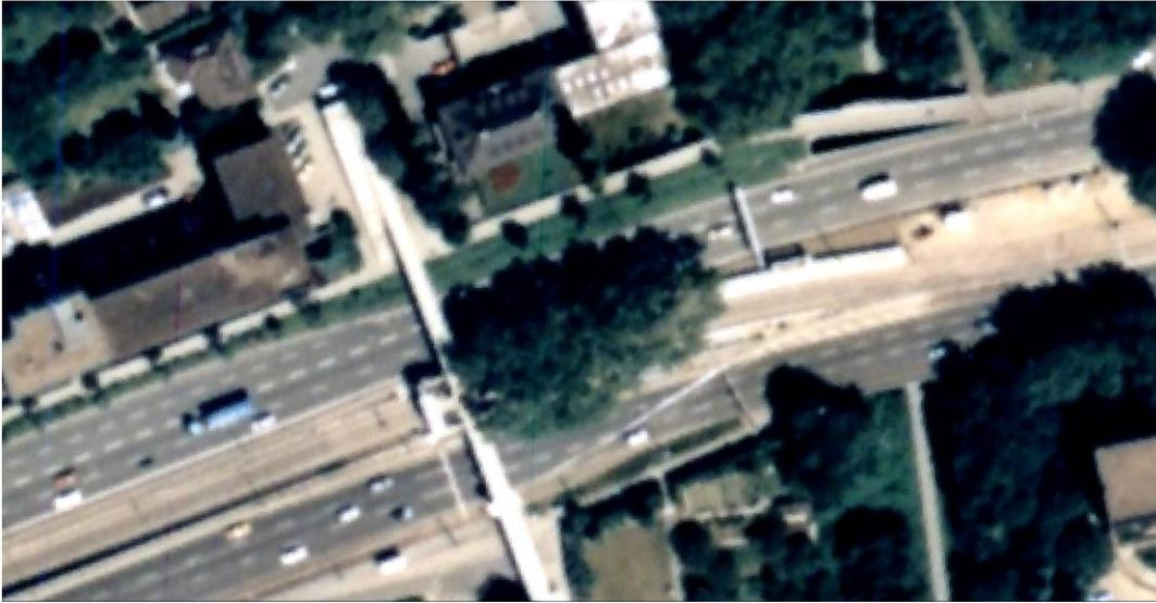
Zustand nach Errichtung der Haltestelle mit Fußgängerbrücke 1990. In Bildmitte sechs ursprüngliche Platanen, deren Erhalt 1980 vom Rat beschlossen wurde. Die Alleelücke östlich davon ist der Gleis-Verschwenkung aus der Mittellage in die Südlage geschuldet.
